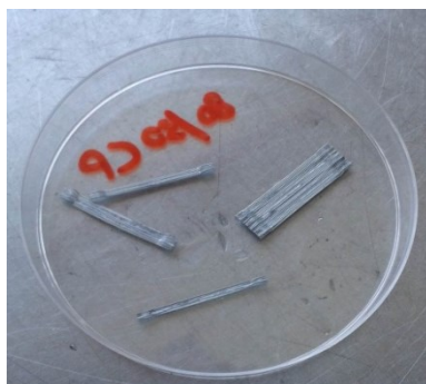
Fibre anticorrosione, prova superata
