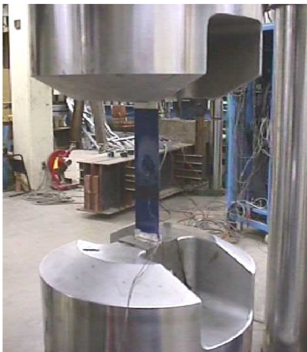
Esecuzione del test secondo ASTM D3039
