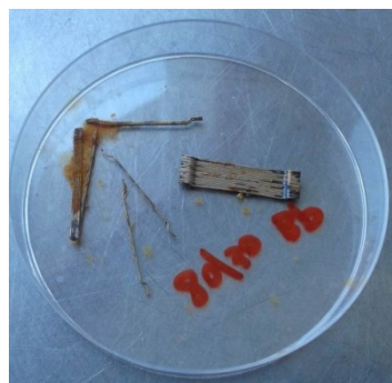
Fibre corrodibili, prova non superata
